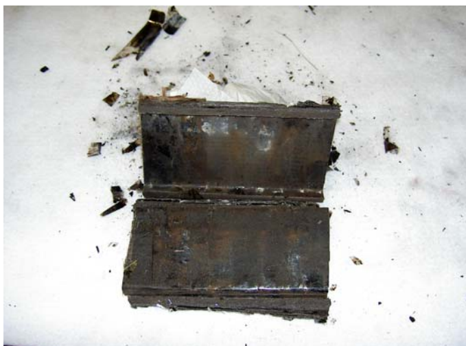
Figur 5 – Exempel på kraftig termisk åldring.
