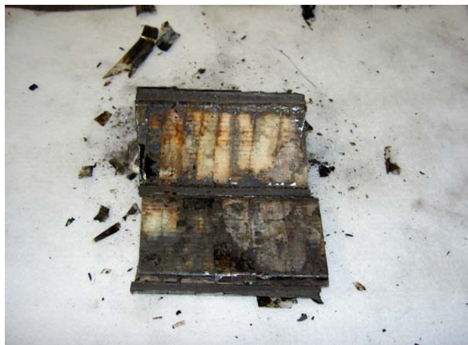
Figur 7 – Exempel på omfattande inre glimningsskador.
